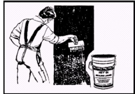
**PASO 3** – Inmediatamente después que se ha aplicado **HEY'DI POWDER X SYSTEM** (finalizado el Paso 2), frote otra capa de **HEY'DI POWDER X SYSTEM** en la superficie mojada.
