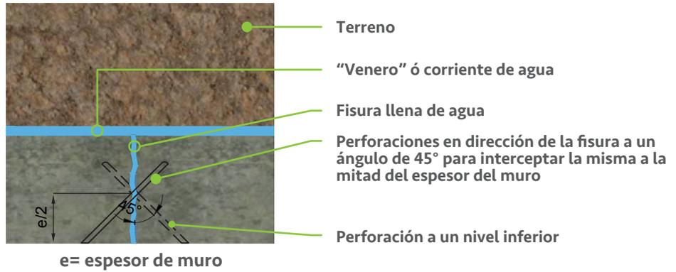
**Figura 5.** Vista en corte superior – inyección con DURAL AQUA -DAM restringiendo el paso del agua por la fisura.
