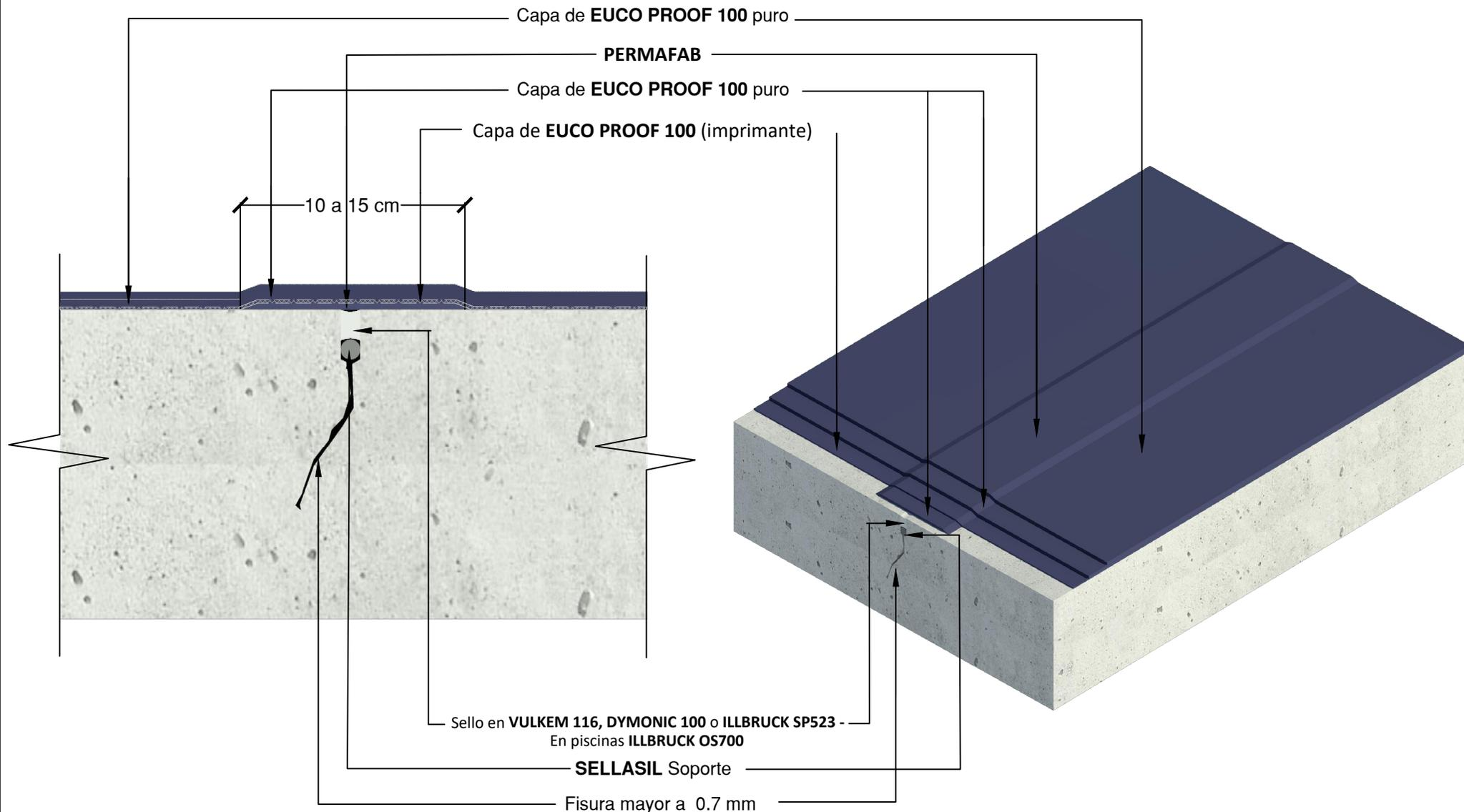
**Nota:** **EUCO PROOF 100** es un sistema impermeabilizante que no debe quedar expuesto a la intemperie, por lo tanto, siempre debe ir recubierto con un acabado, sistema de enchape u otro impermeabilizante resistente a los rayos UV.
