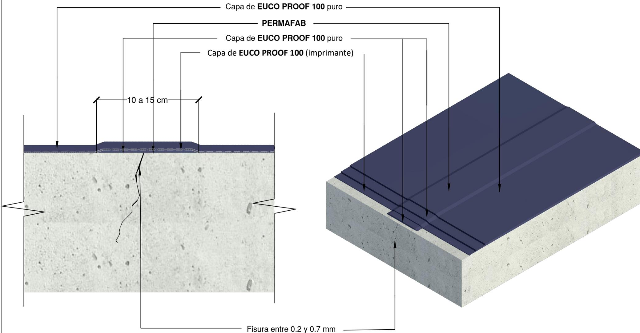
**Nota:** **EUCO PROOF 100** es un sistema impermeabilizante que no debe quedar expuesto a la intemperie, por lo tanto, siempre debe ir recubierto con un acabado, sistema de enchape u otro impermeabilizante resistente a los rayos UV.
