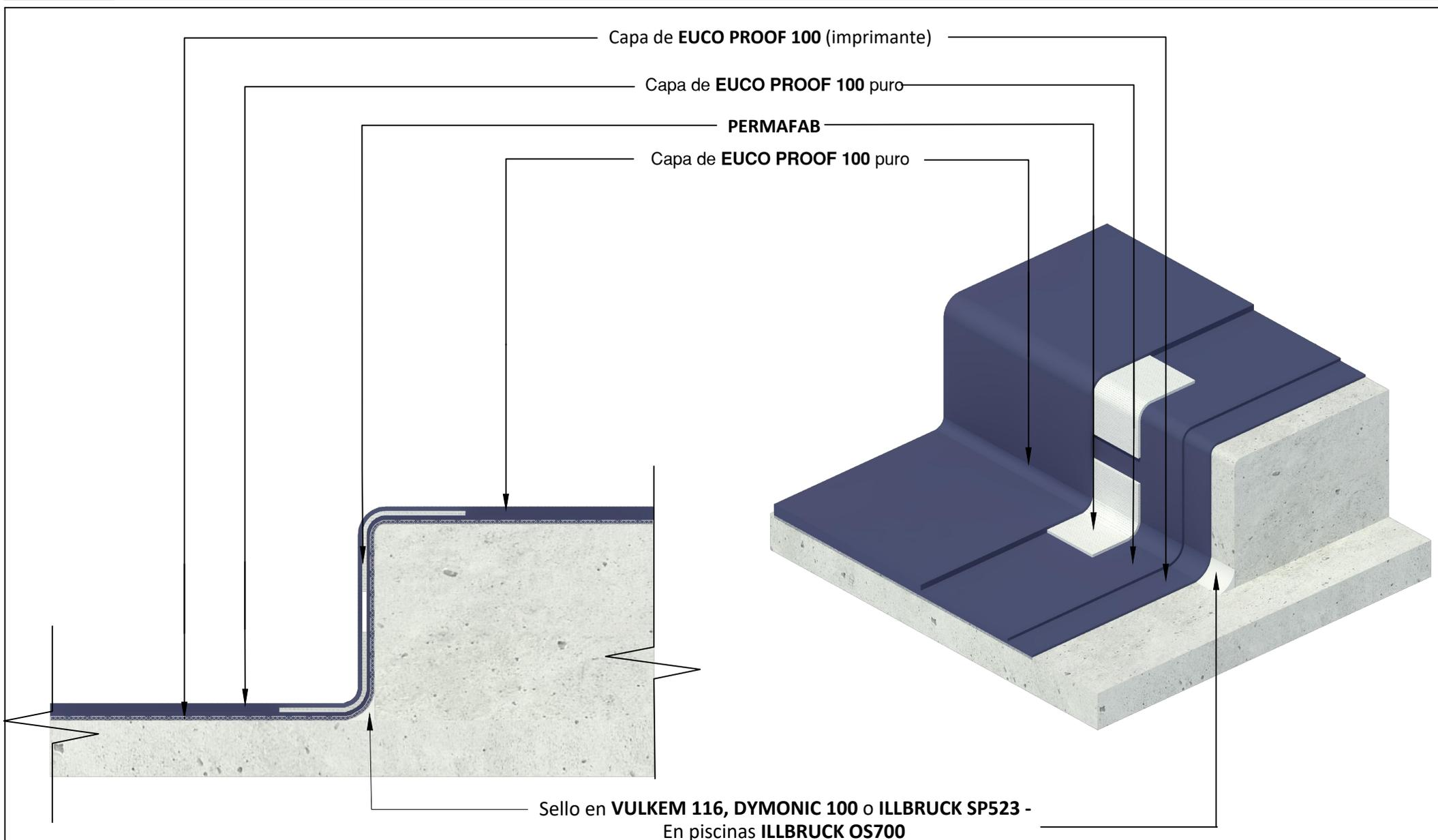
**Nota:** **EUCO PROOF 100** es un sistema impermeabilizante que no debe quedar expuesto a la intemperie, por lo tanto, siempre debe ir recubierto con un acabado, sistema de enchape u otro impermeabilizante resistente a los rayos UV.
