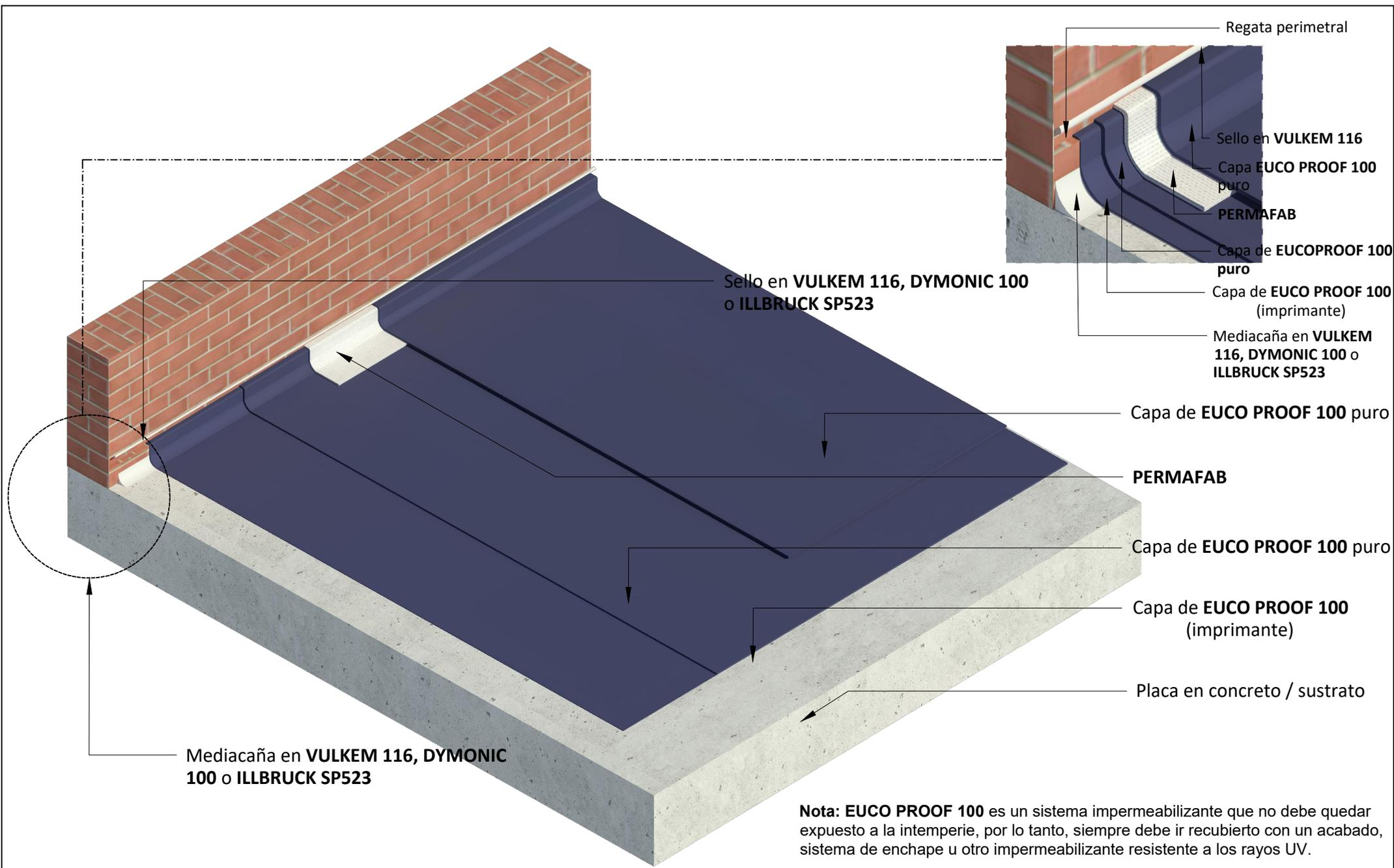
**Nota:** EUCO PROOF 100 es un sistema impermeabilizante que no debe quedar expuesto a la intemperie, por lo tanto, siempre debe ir recubierto con un acabado, sistema de enchape u otro impermeabilizante resistente a los rayos UV.
